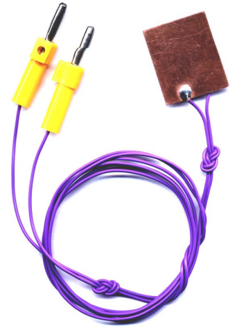
Selbstgebaute Sensoren aus Leiterplattenmaterial
