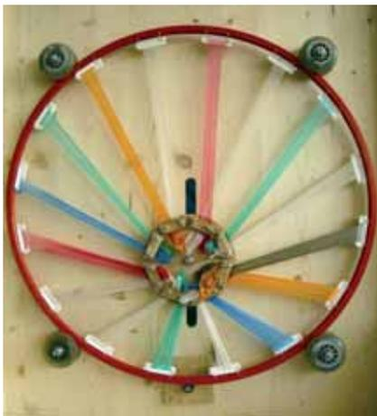
Umkehrung des Latexmotors. Ein exzentrisch gelagertes Rad wird angetrieben. Die Speichen aus Latex spannen (warm) und entspannen sich (kalt).
